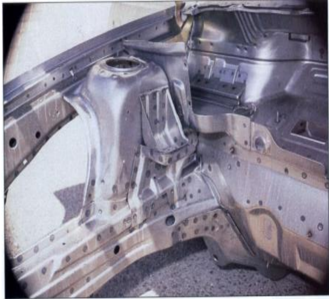
La soldadura por puntos de resistencia es la técnica de ensamble más generalizada.
