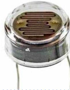
Suelen ser utilizados como sensores de luz ambiental o como una fotocélula que activa un determinado proceso en ausencia o presencia de luz.
