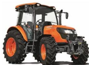
Es un vehículo autopropulsado que se usa para arrastrar o empujar remolques. Se pueden utilizar en diferentes sectores: agricultura, náutica, construcción, movimiento de tierras...
