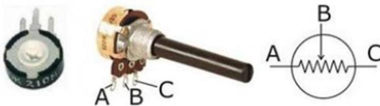
Cualquier símbolo electrónico que tenga una flecha cruzándole significa que es variable. En este caso, una resistencia variable o potenciómetro sería:
