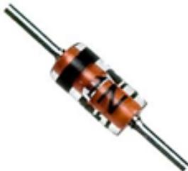
Los diodos zener o simplemente zener, son diodos que están diseñados para mantener un voltaje constante en su terminales, llamado Voltaje o Tensión Zener ( $V_z$ ) cuando se polarizan inversamente, es decir cuando está el cátodo con una tensión positiva y el ánodo negativa.
