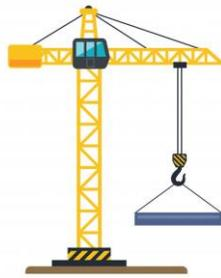
Es una máquina que permite subir y bajar elementos pesados o cuyo movimiento puede resultar complicado. Las cargas son alzadas siendo colocadas en un gancho que se encuentra al final de una cuerda o cadena.
