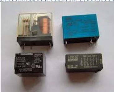
Es un elemento que funciona como un interruptor accionado eléctricamente. Tiene dos circuitos diferenciados. Un circuito de una bobina que cuando es activada por corriente eléctrica cambia el estado de los contactos. Los contactos activarán o desactivarán otro circuito diferente al de activación de la bobina. Puede tener uno o más contactos y estos pueden ser abiertos o cerrados. Aquí puedes ver varios tipos:
