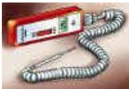
Estos termómetros miden la temperatura en el punto de conexión de dos alambres finos colocados en la punta de la sonda. Las termocuplas que se usan en los laboratorios científicos poseen sondas muy finas, similares a las agujas hipodérmicas, mientras que otros pueden tener sondas tan gruesas como de 1/16 de pulgada.
