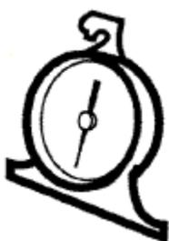
Se puede dejar en el horno un termómetro de este tipo a fin de verificar que el horno se caliente a la temperatura deseada. Estos termómetros bimetalicos pueden medir temperaturas de 100 a 600 °F (37.77 a 315.55 °C)
