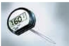
El grosor de la sonda es aproximadamente 1/8 de pulgada y tarda unos 10 segundos para indicar la temperatura en la pantalla digital. Como el semiconductor está en la punta, los termómetros con resistencia térmica pueden registrar la temperatura de alimentos gruesos o de poco grosor.
